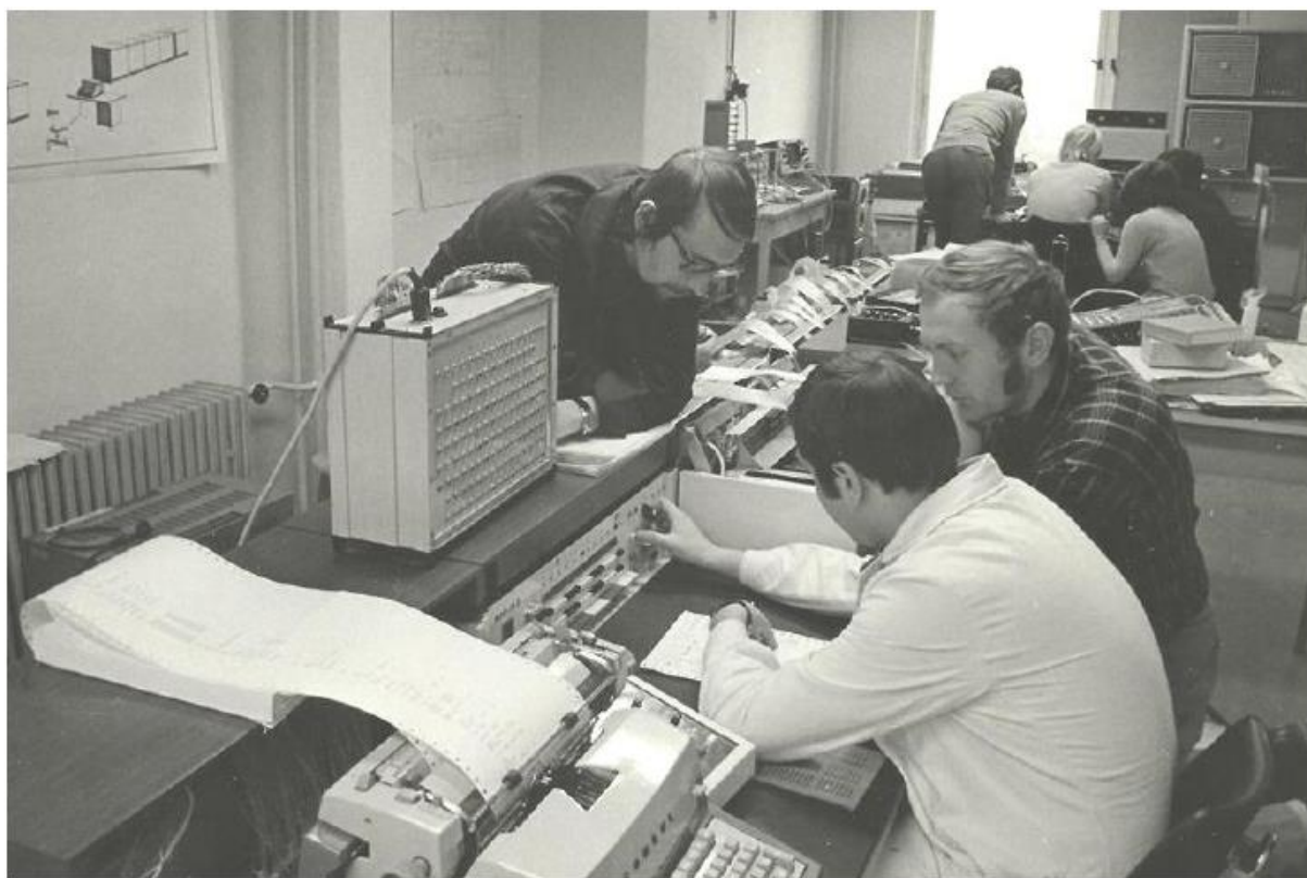
Obrázok 3 Záber z testovania veľkodoskového prototypu (VD PT) počítača RPP 16S pred štátnymi skúškami v 4.Q r. 1973, ktoré mali rozhodnúť o tom, či počítač bude schválený do výroby. Prototyp počítača bol vyvinutý a vyrobený v TESLE Orava, VVL Žilina v r. 1973.
