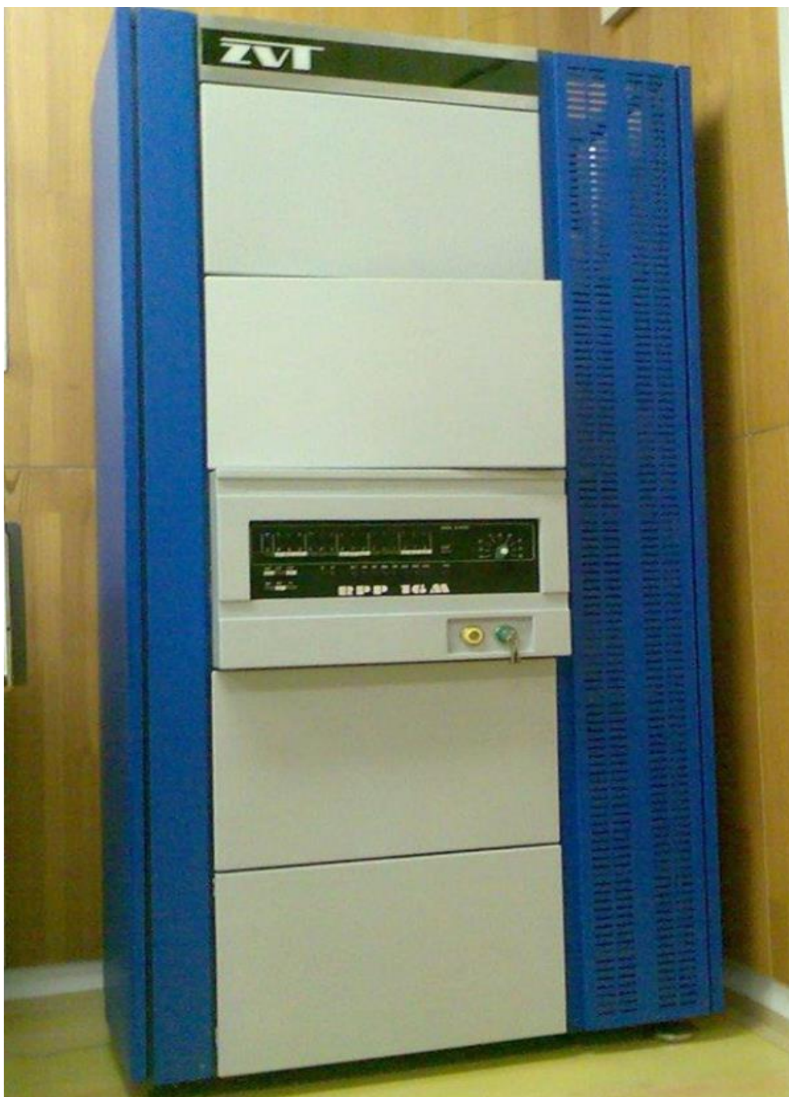
Obrázok 4 Inovované stojanové prevedenie počítača RPP 16M, ktoré vzniklo vo VVL Žilina.
