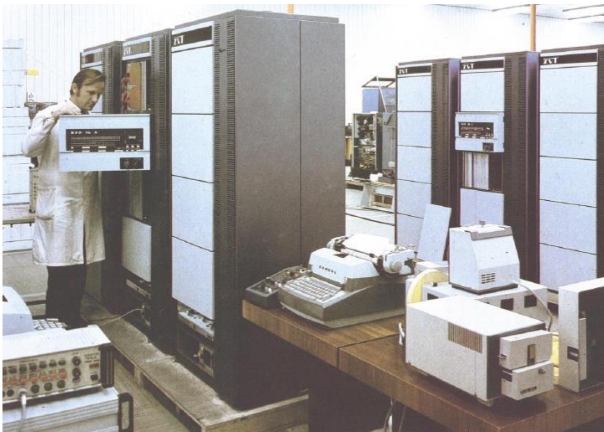
Obrázok 5 Pohľad na inovované stojanové prevedenie počítača RPP 16S vo výrobe v Námestove. V základnej zostave počítač pozostával z troch 19" stojanov (prvý v strede obsahoval: dvojrošt procesora, rošt feritovej operačnej pamäti 16K18 a rošt bloku prenosových kanálov), druhý stojan obsahoval rozšírenie feritovej operačnej pamäti do 64K18 a tretí obsahoval bloky jednotiek medzistyku a riadiace jednotky prídavných zariadení a zo stola referenčných prídavných zariadení. Jednotka styku s prostredím sa inštalovala do samostatných špeciálnych stojanov.
