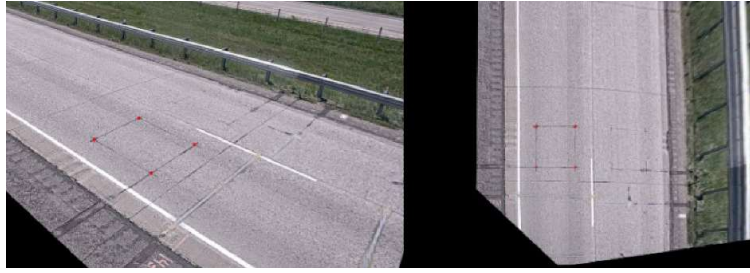
Obr. 4: Demonštrácia syntetickej transformácie pohľadu na vozovku pomocou homografie.
