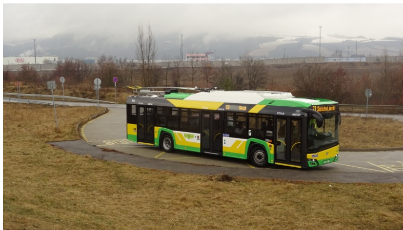
Obrázok 3.4: Parciálny trolejbus používaný DPMŽ v Mojsí pri Žiline, kde nevedie trolejové vedenie [10]
