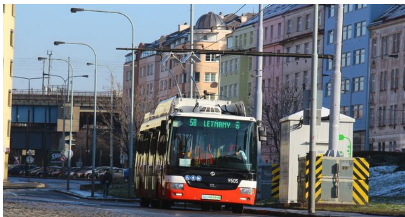
Obrázok 3.3: Parciálny trolejbus, ktorý práve používa zariadenie na pripájanie sa k trolejovému vedeniu [24]
